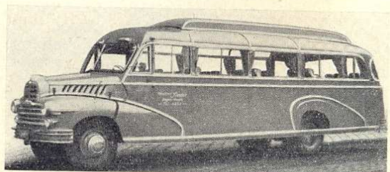
Bild 1. Omnibus der klassischen Bauform (Reisecomnibus von Borgward mit Aero-Aufbau)
