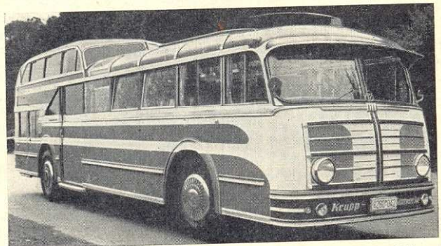
Bild 3. Omnibus mit vorgezogenem Aufbau. Fahrgestell der Krupp-Südwerke (Zweitakt-Motor). Aufbau (Luxus-Ausführung) von Gebr. Ludwig, Essen-Altessen
