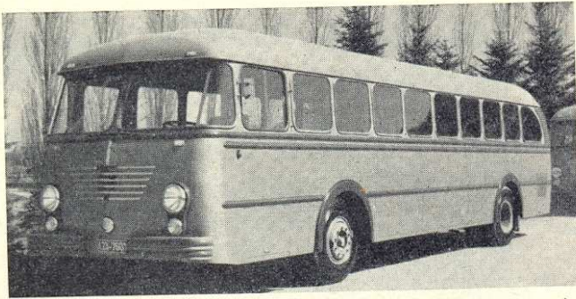
Bild 2. Klatte-Leichtomnibus. Selbsttragender Aufbau in Schalenbauweise. 175-PS-Deutz-Motor, 100—120 km/h, Gesamtgewicht besetzt 13,5 t. Einzeln gefederte Vorderräder
